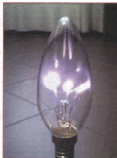
foto 3 Lampada a filamento come sfera al plasma
