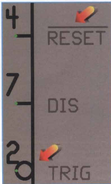
figura 16 Migliorare la serigrafia con linee (in alto) e cerchi di negazione (in basso)
