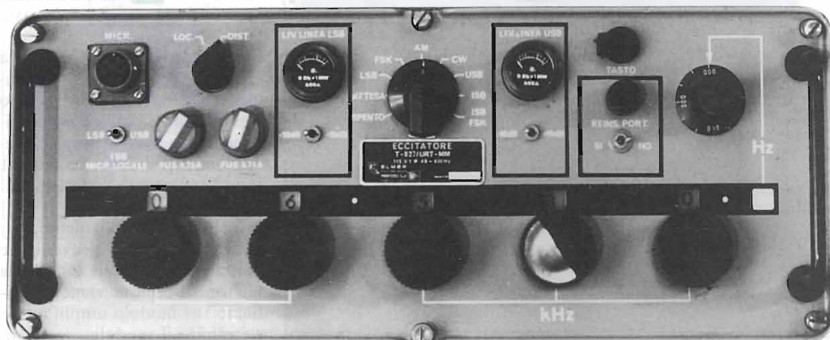
foto 1 Frontale dell'eccitatore; notare al centro della parte destra il commutatore ed il potenziometro per l'eventuale reinserimento della portante
